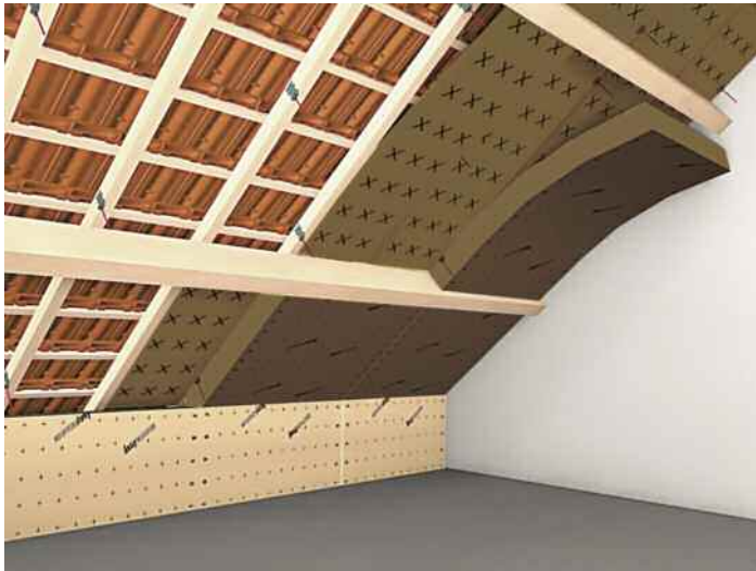
Рис. 6. Утепление кровли со стороны внутреннего объема подстропильного пространства
